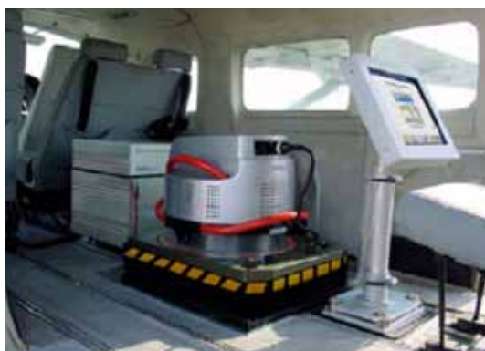
Fig. 5.19 Cámara ADS40 (Montesinos et al. , 2007)
