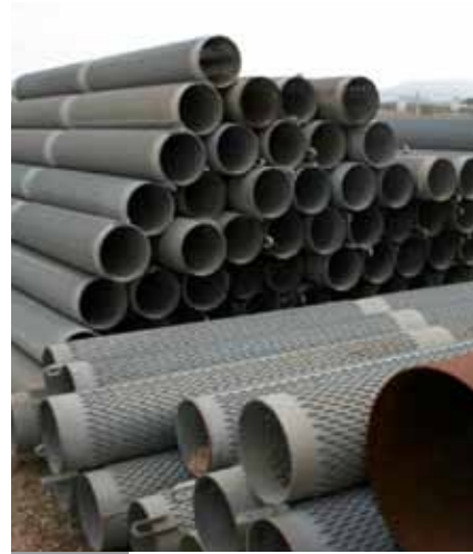
Fig. 3.7 Camisas para el recubrimiento de pozos
